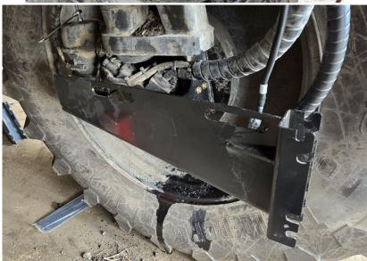
5. TIGHTEN ALL BOLTS, RELEASE THE BRAKES & REPEAT ON THE RIGHT SIDE.
